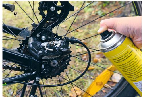
Zum Schluss sprüht Julius seine Kette, die Zahnräder, Lager, Federelemente und Schraubverbindungen mit einem Universal-Schmiermittel ein.
