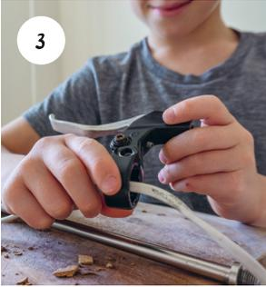
3 Das Kabel der Lampe in die Halterung des Bremshebels stecken.
