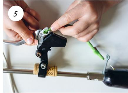
5 Den Zugschalter über eine Schnur mit dem Bremshebel verbinden.
