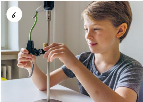
6 Die Bremse mit dem Korken soweit hinunterziehen, bis die Schnur gespannt ist.
