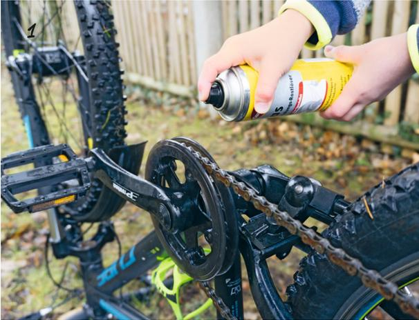
Das Kettenblatt und die Zahnkränze mit Kettenspray einsprühen. Leg einen alten Lappen unter, und pass auf, dass kein Öl auf die Felge oder die Scheibenbremsen gelangt. Sonst funktionieren die Bremsen nicht mehr richtig.
