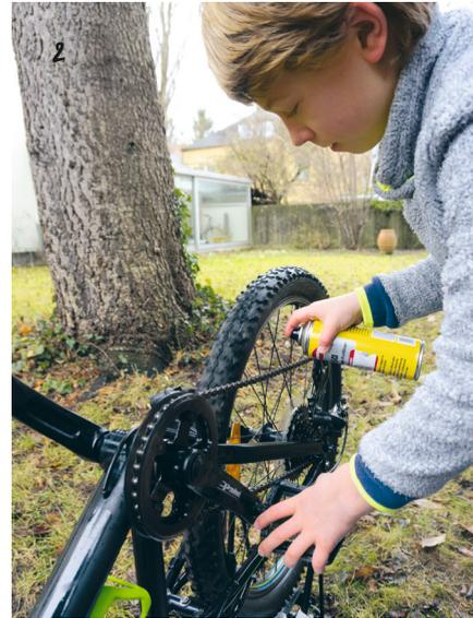
Mit der einen Hand ein Pedal drehen und die vorbeilaufende Kette mit dem Kettenspray in der anderen Hand sparsam, aber gleichmäßig einsprühen.
